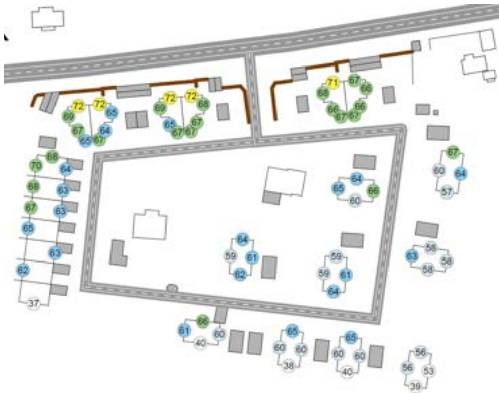
Bilaga 4 bullerutredning: maximal ljudnivå 60 km/h med bullerskydd, prognostiserad trafik för år 2040.
