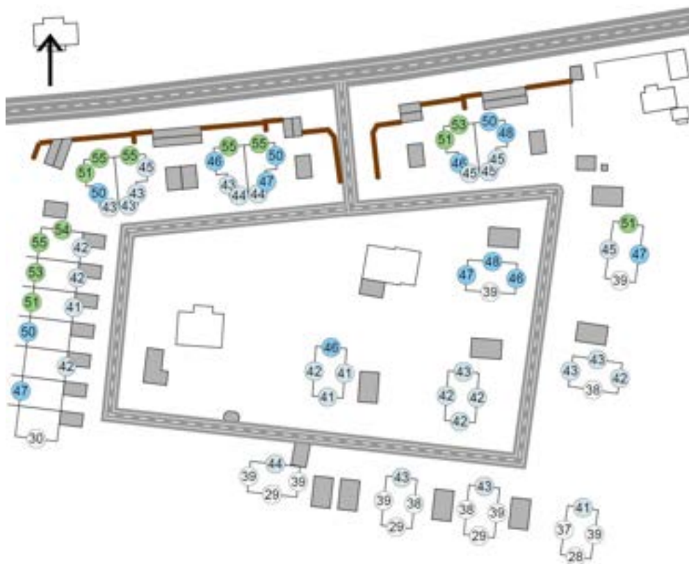
Bilaga 2 bullerutredning: ekvivalent ljudnivå 60 km/h med bullerskydd, prognostiserad trafik för år 2040.
